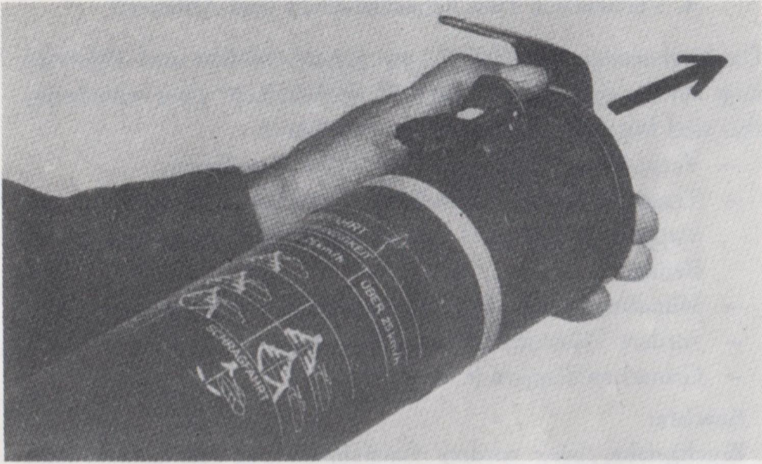
Abb. 18: Abnehmen des Mündungsdeckels
