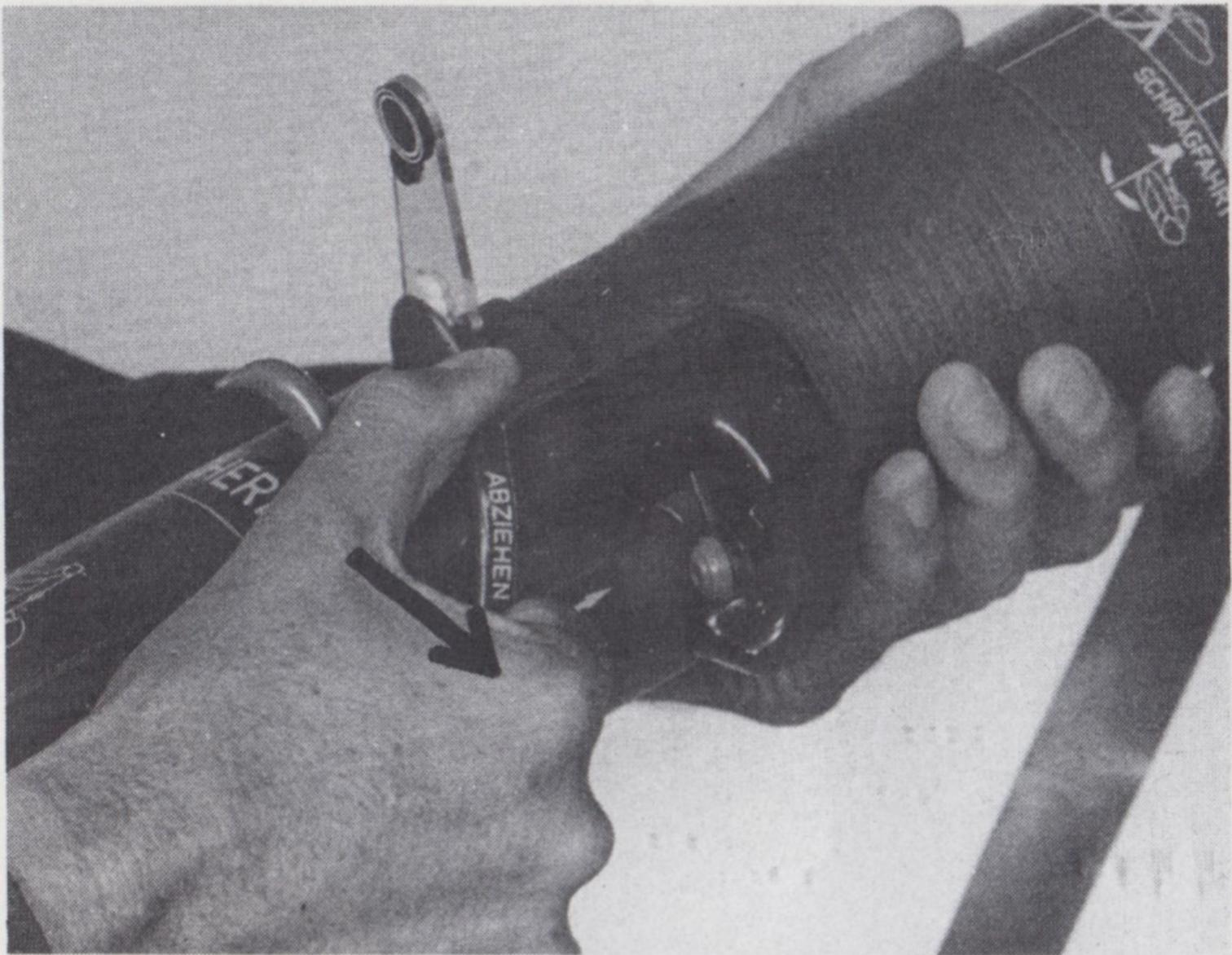
Abb. 21: Abziehen der Transportsicherung
